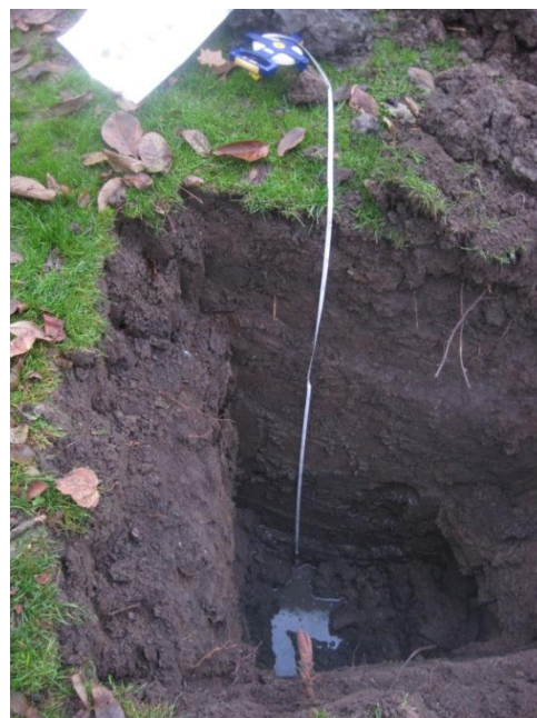
Sonda S 1 (při dně hladina podzemní vody)
