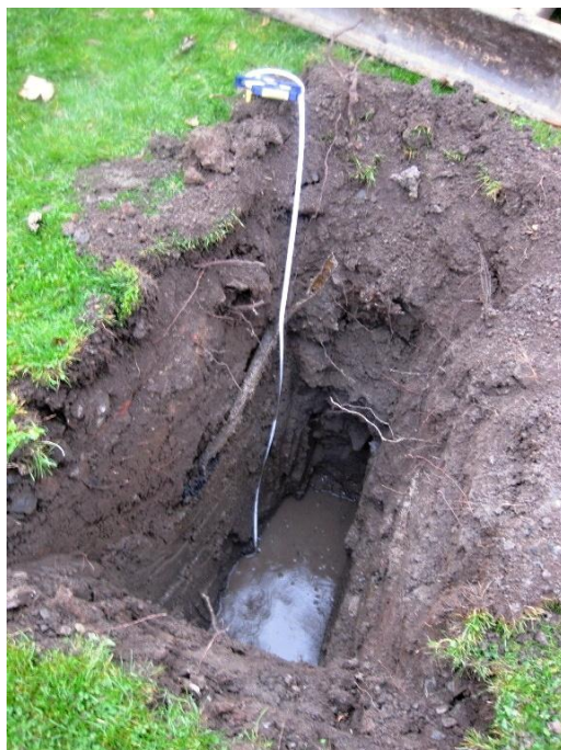
Sonda S 2 s vystavenou hladinou podzemní vody
