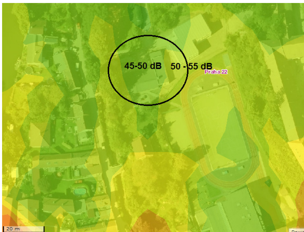
Obr. č. 3: Výřez hlukové mapy dotčeného území a znárodnění hlukových pásem z automobilové dopravy pro denní dobu, L_{Aeq,16h}
