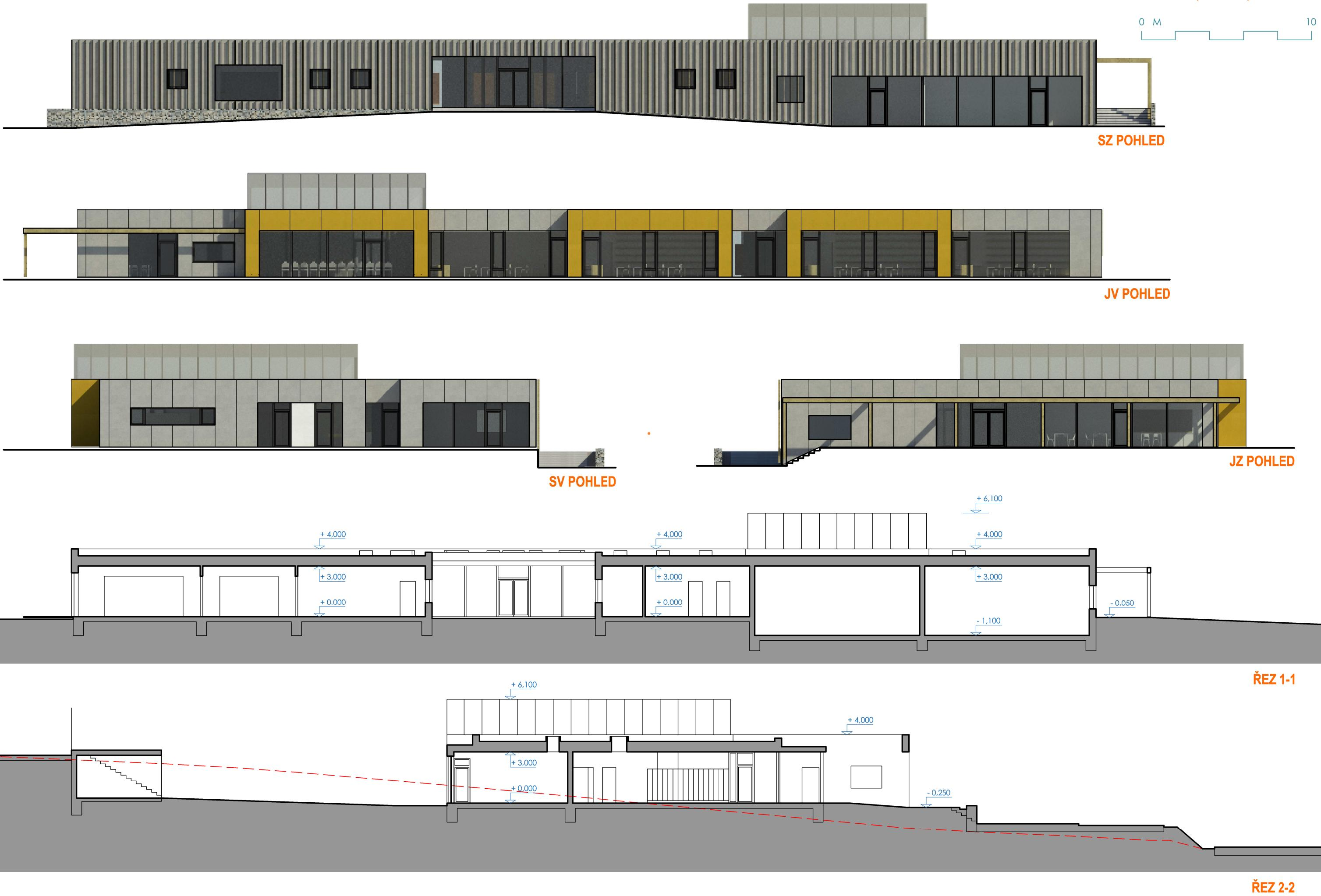
Nosná konstrukce stavby bude kombinací prvků z válcované oceli a rastru z tenkostěnných pozinkovaných profilů. Základní osnova komponentů z válcované oceli poskytuje variabilitu vnitřního uspořádání. Zásadní předností konstrukčního systému je rychlosť výstavby, protože mokré stavební procesy jsou omezeny na minimum (základové konstrukce).
